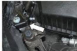
2. Установить кронштейн крыла, как показано на рисунке. Плотно прижать кронштейн к кузову. Закрепить кронштейн болтом M8x20 с шайбой 8. Болт затянуть ключом №13 с усилием 23 Нм.
