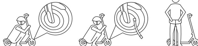
Если колесо электросамоката немного спущено, снимите колпак ниппеля колеса и прикрутите штуцер, после чего можно подкачать колесо.
