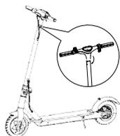
5. С обеих сторон зафиксируйте руль с помощью четырёх винтов М3 и шестигранного ключа из комплекта поставки.
