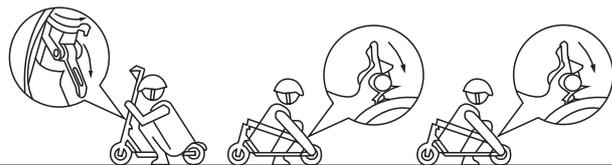
Убедитесь, что электросамокат выключен. Ослабьте предохранительный фиксатор (2) и фиксатор (1), сложите рулевую стойку в горизонтальное положение. Зафиксируйте рулевую стойку, продев кольцо-фиксатор на руле через крючок брызговика на заднем колесе. Чтобы разложить электросамокат, отсоедините кольцо-фиксатор от крючка брызговика, затем поднимите рулевую колонку в вертикальное положение, поднимите фиксатор (1) и сдвиньте предохранительный фиксатор (2) влево.
