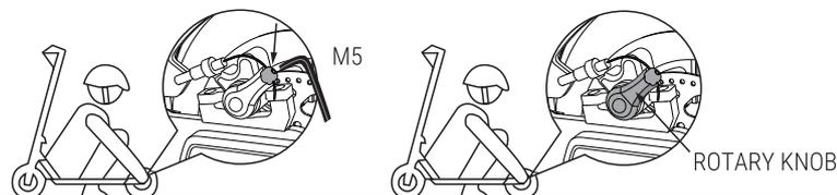
Если тормоз тугой, ослабьте винты натяжного шкива тормозного диска используя шестигранный ключ M5 из набора, немного укоротите длину тормозного троса, после чего затяните винты натяжного шкива.
