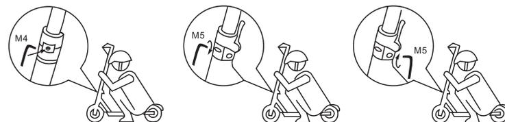
Если рулевая колонка расшатана, затяните два винта возле складного механизма, используя шестигранный ключ M5 из набора.
