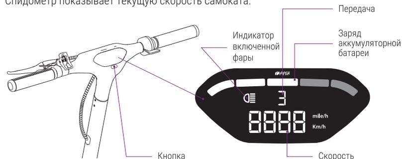
1. Удерживайте кнопку нажатой в течение 2 секунд, чтобы включить или выключить электросамокат. После включения электросамоката должны загореться фара, светодиодная подсветка\*, стоп-сигнал и дисплей.
