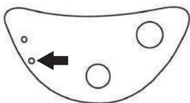
6. После того, как вода закипит, термопот перейдет в режим поддержания температуры. Загорится соответствующий индикатор на панели управления.
