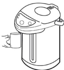
**Розлив с помощью чашки** возможен при надавливании чашкой на специальный рычажок, расположенный у носика термопота. Ни в коем случае не нажимайте на рычажок рукой.
