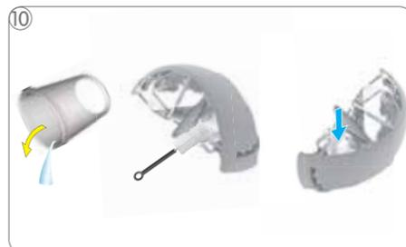
Опорожните и очистите сосуд. Сполосните и промойте емкость для воды. По мере необходимости используйте совместимую с продуктами питания щетку и чистящую жидкость. Затем снова наполните свежей питьевой водой и установите в машину.
