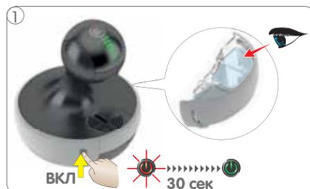
1 Проверьте, чтобы емкость для воды содержала достаточное количество воды. Включите машину. Пока машина нагревается, кнопка включения начинает мигать красным. После прибл. 30 секунд кнопка включения загорается постоянным зеленым светом, и машина готова.
