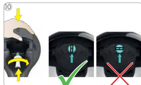
Вставьте инжектор снизу вверх в отверстие машины. Поддерживайте инжектор рукой. Поверните инжектор по часовой стрелке до фиксации. Следуйте указаниям в «8. УДАЛЕНИЕ НАКИПИ НЕ РЕЖЕ ЧЕМ РАЗ В 3 – 4 МЕСЯЦА» на стр. 13.
