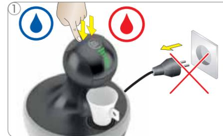
**Всегда держите машину в вертикальном положении!** Чтобы остановить приготовление, снова коснитесь символа горячей/холодной воды. Не отключайте машину от розетки! В машине сбрасывается давление.
