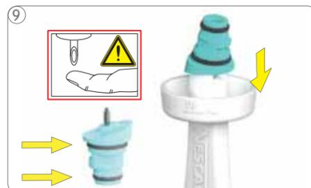
Проверьте невредимость обоих уплотнительных колец круглого сечения и правильность их размещения на инжекторе. Поместите инжектор в устройство извлечения инжектора.
