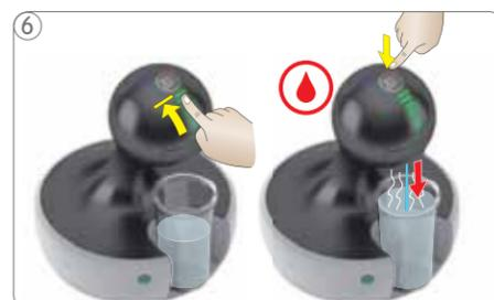
6 Продолжите промывку горячей водой: Настройте на штриховом индикаторе максимальный уровень с помощью сенсорной поверхности выбора объема. Коснитесь символа горячей воды. Машина начинает выполнение промывки.
