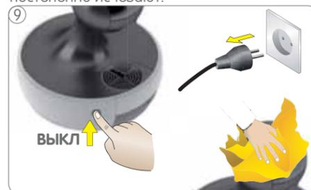
Выключите машину. Вытяните вилку из розетки. Очистите машину мягкой влажной тряпкой. Затем просушите мягкой сухой тряпкой.
