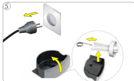
Вытяните вилку из розетки! Переверните поддон. Выньте устройство извлечения инжектора. Вытяните очистительную иглу из устройства извлечения инжектора. **Держите иглу в недоступном для детей месте!**
