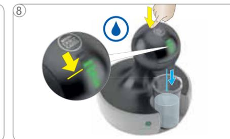
Коснитесь символа холодной воды. Штриховой индикатор начинает обратный отсчет. Машина удаляет накипь в режиме «старт-стоп» в течение около 2 минут вплоть до опорожнения емкости для воды.
