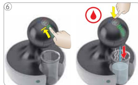
Выполните промывку машины: Установите максимальное количество штрихов на сенсорной поверхности выбора объема. Коснитесь символа горячей воды. Машина начинает выполнение промывки. Штрихи, высвечиваемые на штриховом индикаторе, постепенно исчезают.
