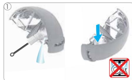
Сполосните и промойте емкость для воды. По мере необходимости используйте совместимую с продуктами питания щетку и чистящую жидкость. Затем снова наполните емкость свежей питьевой водой и установите ее в машину. Емкость для воды не подходит для мытья в посудомоечной машине!
