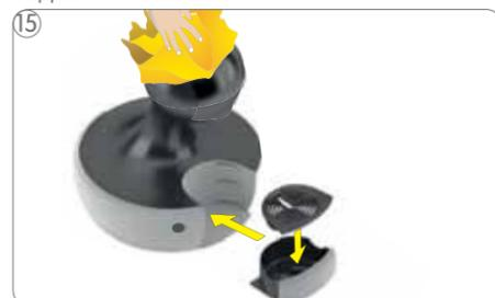
Очистите машину мягкой влажной тряпкой. Затем просушите мягкой сухой тряпкой. Поместите решетку поддона на поддон. Затем поместите поддон в нужное положение на машине.
