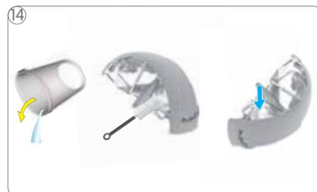
Опорожните и очистите сосуд. Сполосните и промойте емкость для воды. Затем снова заполните ее свежей питьевой водой и вставьте в машину.
