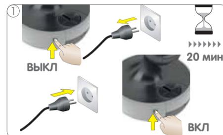
Выключите машину. Проверьте, не зажата ли капсула, см. «9.2 ЖИДКОСТЬ НЕ ПОСТУПАЕТ – БЛОКИРОВКА КАПСУЛЫ / ИНЖЕКТОРА?» на стр. 15. Извлеките вилку питания и подождите 20 минут. Затем вставьте вилку в розетку питания и включите машину.
