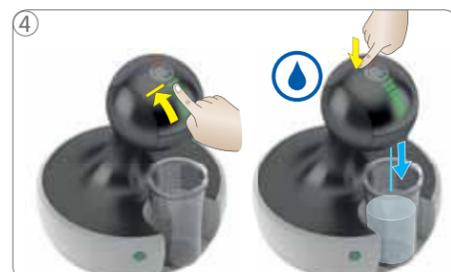
4 Начните промывку холодной водой: Настройте на штриховом индикаторе макс. уровень с помощью сенсорной поверхности выбора объема. Коснитесь символа холодной воды. Машина начинает выполнять промывку.
