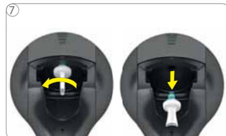
**Удаляйте инжектор только из остывшей машины!** Поверните устройство извлечения инжектора против часовой стрелки. Извлеките инжектор. **Не оставляйте инжектор без присмотра! Держите инжектор в недоступном для детей месте!**
