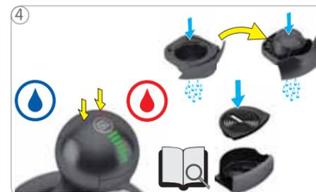
Промойте машину, для этого следуйте указаниям в «5. ПЕРВОЕ ИСПОЛЬЗОВАНИЕ» на стр. 8. Промойте обе стороны держателя капсул жидким моющим средством и свежей питьевой водой. Промойте поддон свежей питьевой водой и прочистите чистой щеткой, совместимой с продуктами питания.
