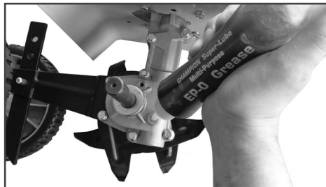
Рис. 24 Добавление смазки в корпус редуктора
