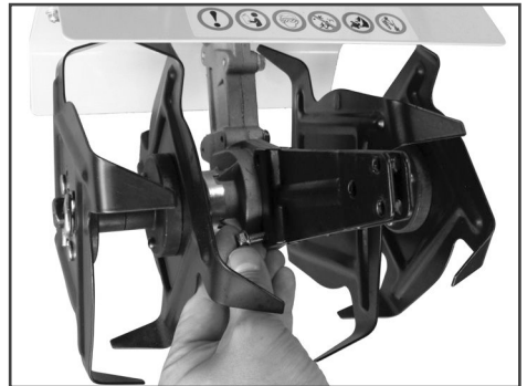
Рис. 5 Установка кронштейна сошника
