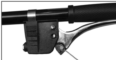
Рис. 9 Установка наконечника троса газа
