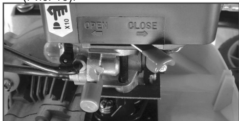
Рис. 16 Воздушная заслонка карбюратора закрыта
