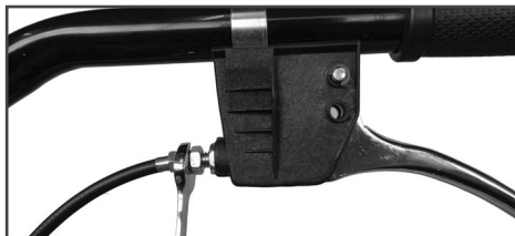
Рис. 10 Установка регулировочной муфты троса газа
