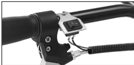
Рис. 13 Подключение проводов к выключателю зажигания
