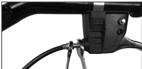
Рис. 12 Фиксация троса газа
