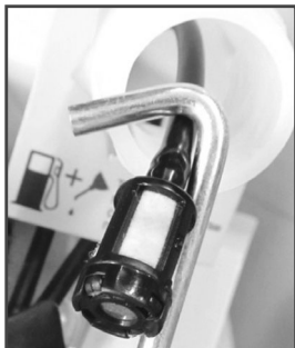
Рис. 21 Извлечение топливного фильтра
