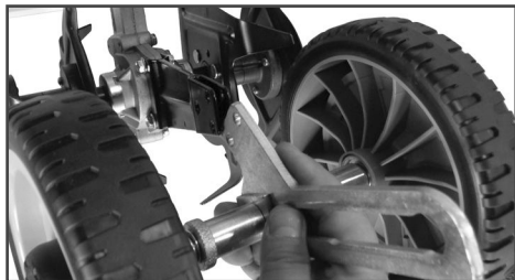
Рис. 6 Установка кронштейна колес
