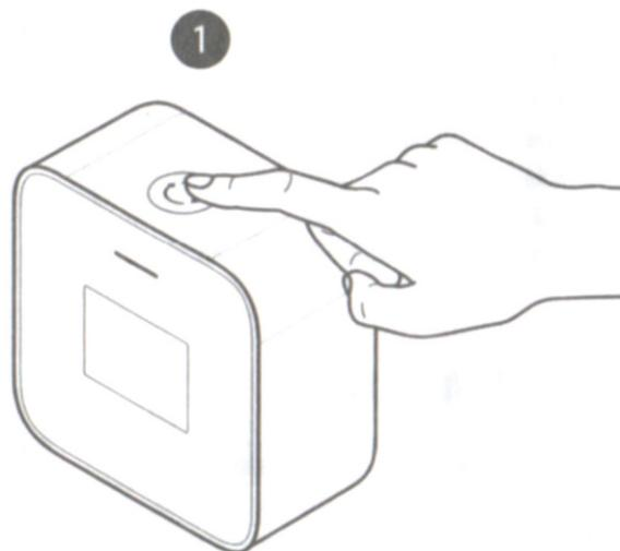
Нажмите на кнопку включения, одновременно с включением прибора загорается световой индикатор.
