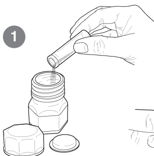
1 В банку с лаком добавить люминафор. Add luminescent powder and acrylic paint.
