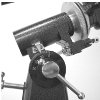
Рис.4-7: круг склонений вверх, прям. восх. - внизу
