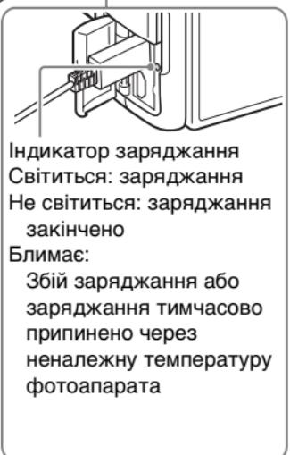
**1** З'єднайте фотоапарат та адаптер змінного струму (додається), використовуючи кабель Micro USB (додається).
