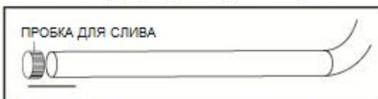
2 Шаг: Снять пробку для слива воды с трубки
